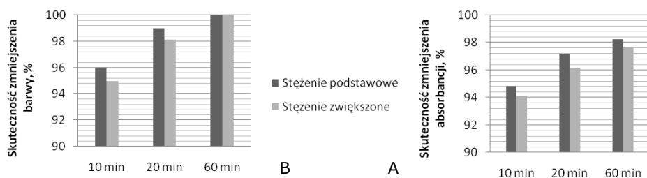
Rys. 7. Skuteczność zmniejszenia barwy (B) oraz absorbancji (A) wody o składzie podstawowym oraz wody o zwiększonym stężeniu jonów siarczanowych po czasie: 10, 20 i 60 min. Dawka żywicy: 15 \text{ cm}^3/\text{dm}^3
