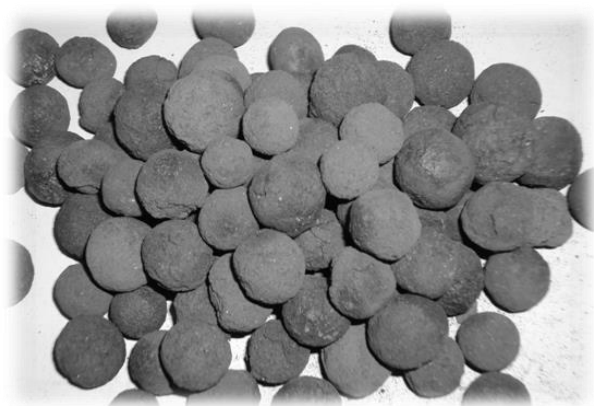
Rys. 2. Granulat typu LECA stanowiący wypełnienie filtrów
