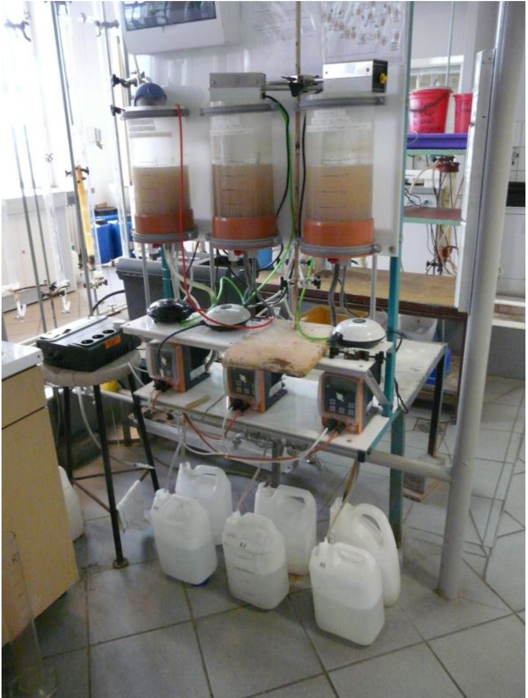
Rys. 1. Stanowisko badawcze – układ reaktorów SBR
