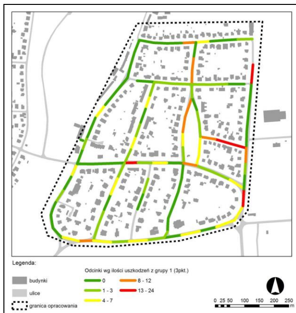
Rys. 3. Wizualizacja odcinków wg ilości uszkodzeń sklasyfikowanych za 3 pkt.
