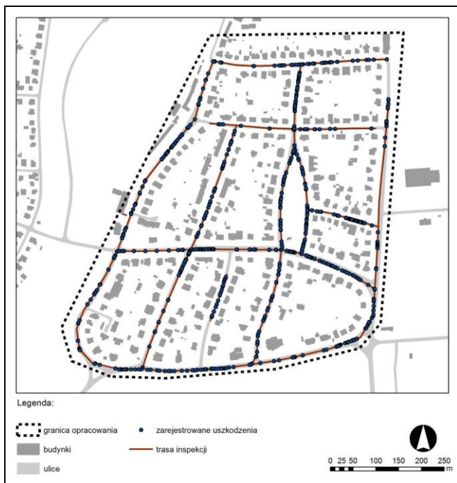
Rys. 2. Trasy inspekcji TV sieci kanalizacji deszczowej oraz zarejestrowane uszkodzenia
