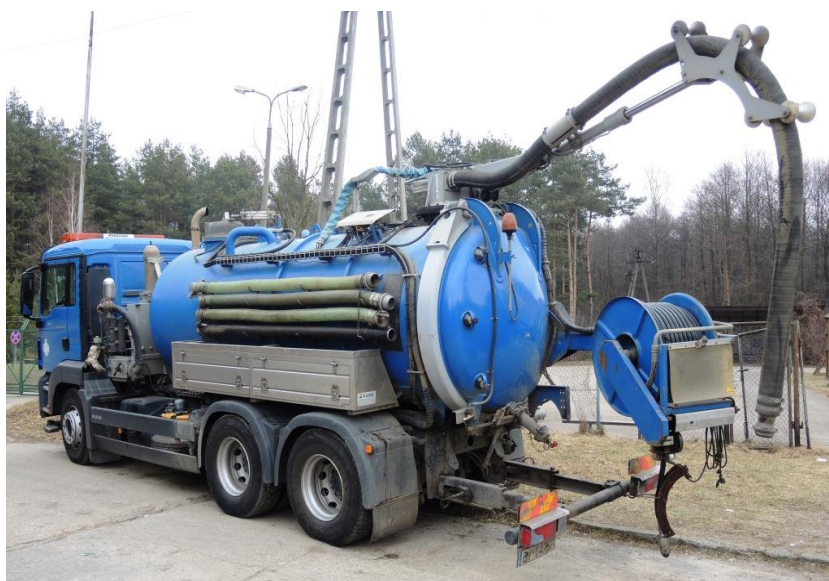
Fot. 5. Samochód specjalny ssąco-płuczący z odzyskiem wody typu ECO-kombi (firmy KAISER)
