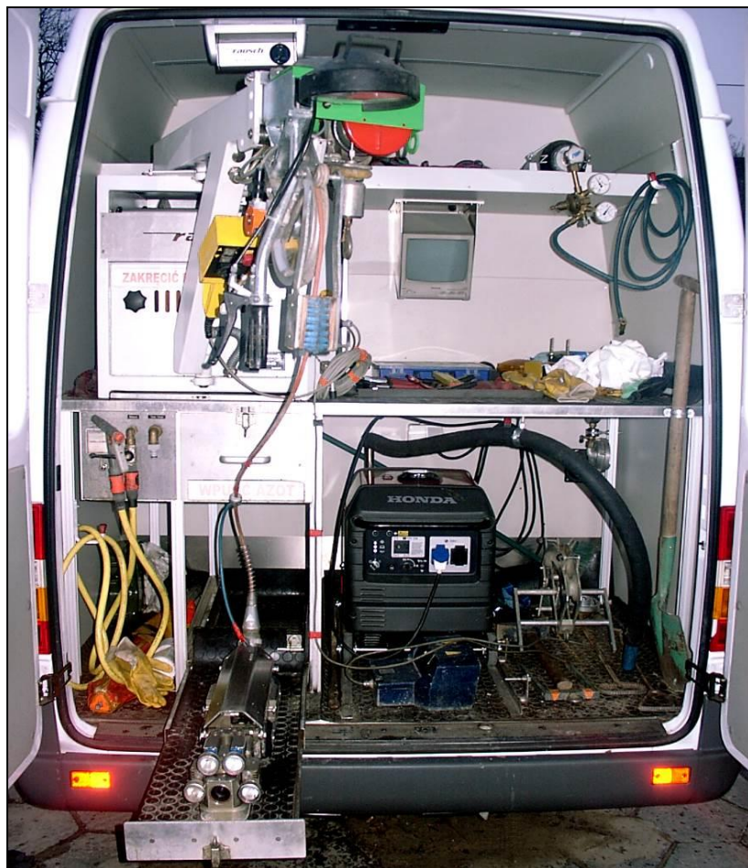
Fot. 4. Przedział tylny samochodu inspekcyjnego (firmy Rausch)
