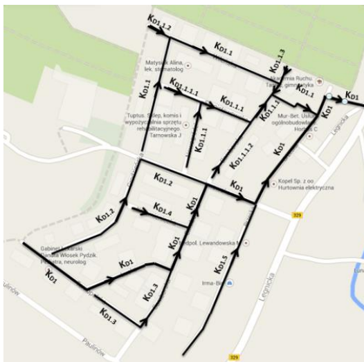
Rys. 1 Schemat kanalizacji deszczowej na terenie analizowanej zlewni
