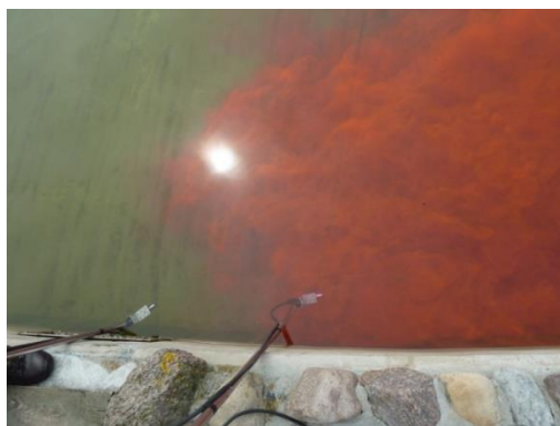
Fot. 2. Zbliżenie się traseru do odpływu z basenu nr 7 z umieszczonymi sondami pomiarowymi
