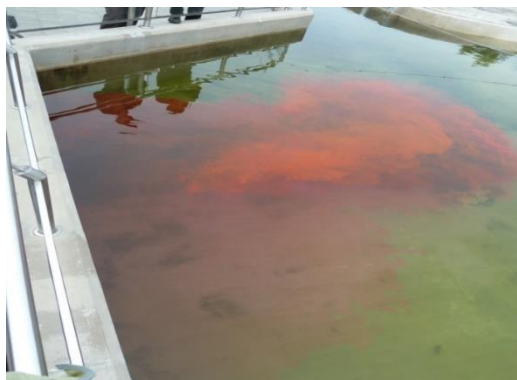
Fot. 1. Propagacja traseru po wpuszczeniu dawki znacznika do basenu nr 7
