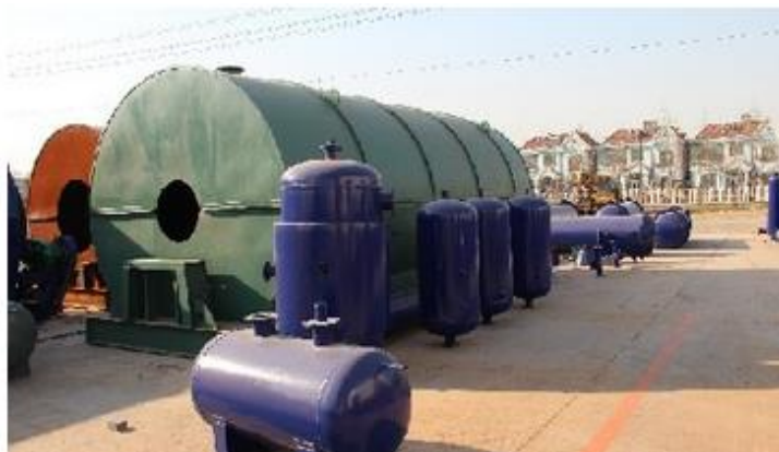
Rys. 3. Urządzenie do procesu pirolizy zużytych opon [28]
