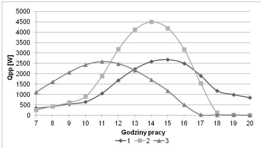
Rys. 3. Godzinowy bilans ciepła od nasłonecznienia określony dla pomieszczenia dla 22 września; oznaczenia:
