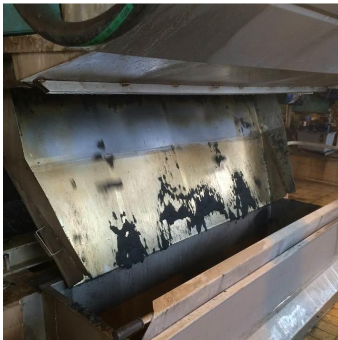
Rys. 1. Osad odwodniony na prasie taśmowej
