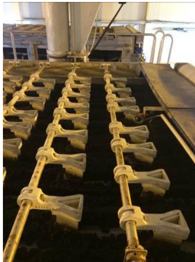
Rys. 4. Osad zagęszczony flokulantem bruzdowany na wejściu prasy taśmowej
